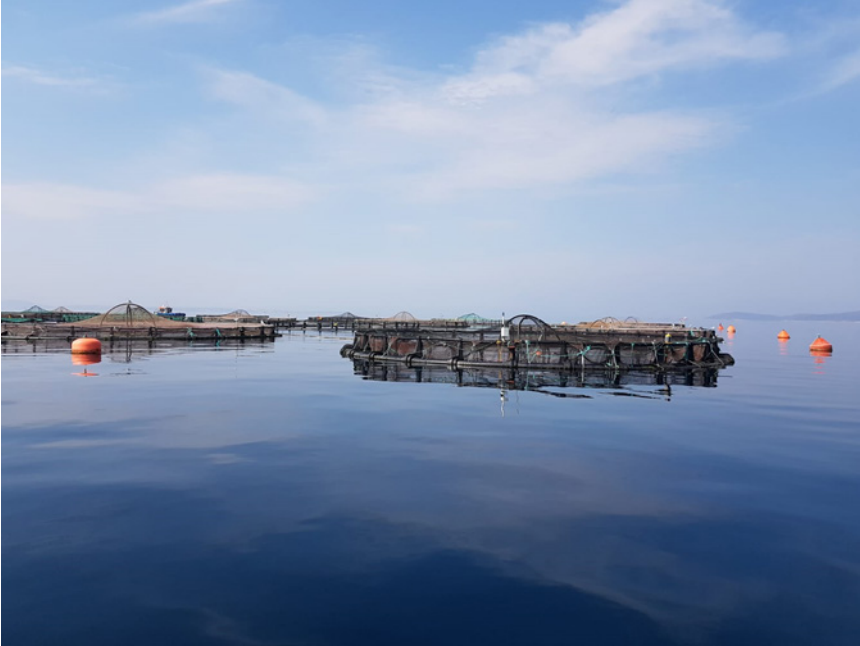
Şekil 10. Deniz balıkları yetiştiriciliğinde kullanılan ağ kafesler
