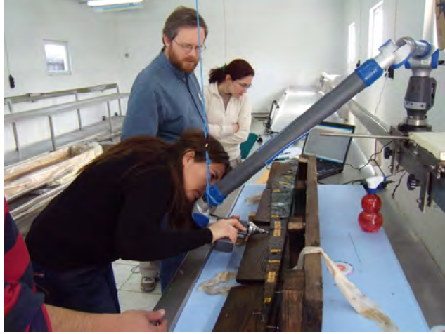
Şekil 7. Elektronik çizim cihazı ile gemi elemanlarının detay çizimleri.
